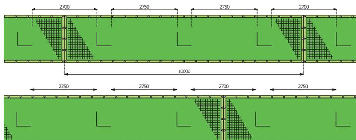
通常、防風ネットは複数枚連続して設置します。一般的な風抜穴付防風ネットは風抜穴が1枚では等間隔ですが、連続すると間隔が短くなります。カネヤの風抜穴付防風ネットは連続して設置しても風抜穴が等間隔になるように設計されています。(別注サイズは基本風抜穴の中心位置が等間隔になります。)
